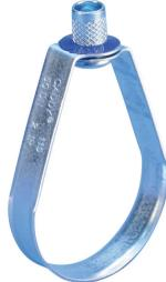
Die 115M Standard-Duty-Rohrschlaufe ist ideal für die Aufhängung von nicht isolierten Rohrleitungen, einschließlich CPVC-Rohren, in Feuerlöschsystemen. Eine geriffelte Mutter vereinfacht die vertikalen Justierungen und aufgebördelte Kanten auf der Grundfläche (Größen von 1,27 cm (1/2 in) bis 10,16 cm (4 in)) hilft beim Schutz der Rohre vor Kontakt mit scharfen Oberflächen der Rohrschlaufe.
