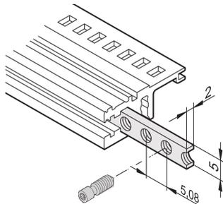
Der Gewindestreifen aus Stahl mit M2,5 Gewinde, ermöglicht die Befestigung der Lochschiene an der Tragschiene.
