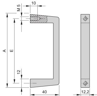
Der Griff kann an einem Baugruppenträger oder einer 19"-Frontplatte montiert werden. Erhältlich mit transparenter oder schwarz eloxierter Oberfläche. Die Griffe werden von der Rückseite verschraubt.
