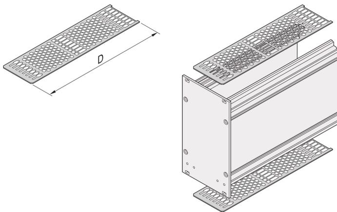
Deckblech für Kassetten mit Perforation zur Befestigung von Führungsschienen. Die Perforation garantiert einen Luftstrom von ca. 60 %. Das Blech wird in eine Nut in der Seitenwand geschoben.
