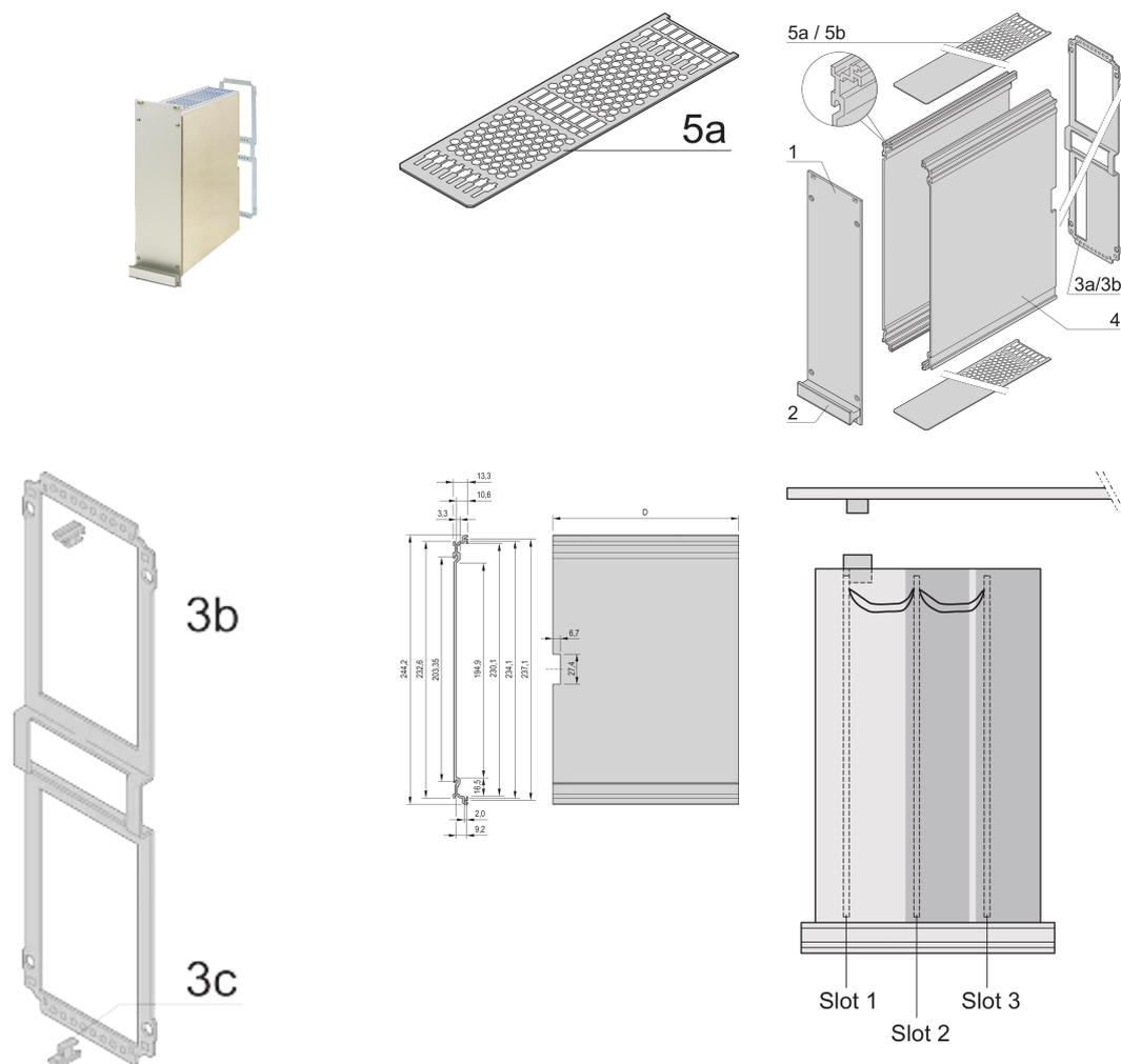
Kassette, nicht abgeschirmt, perforierte Deck-/Bodenabdeckung, Rückwand mit Ausbruch für mehr Steckverbinder.
