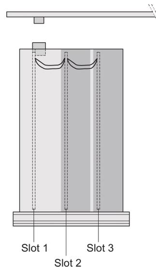
Kassette, nicht abgeschirmt, perforierte Deck-/Bodenabdeckung, Rückwand mit Ausbruch für einen Steckverbinder.
