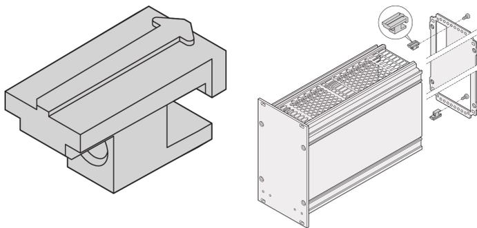
Rückwandhalter für Kassetten, Satz mit Befestigungsschrauben. Zur Erhöhung der Stabilität von breiteren Kassetten.
