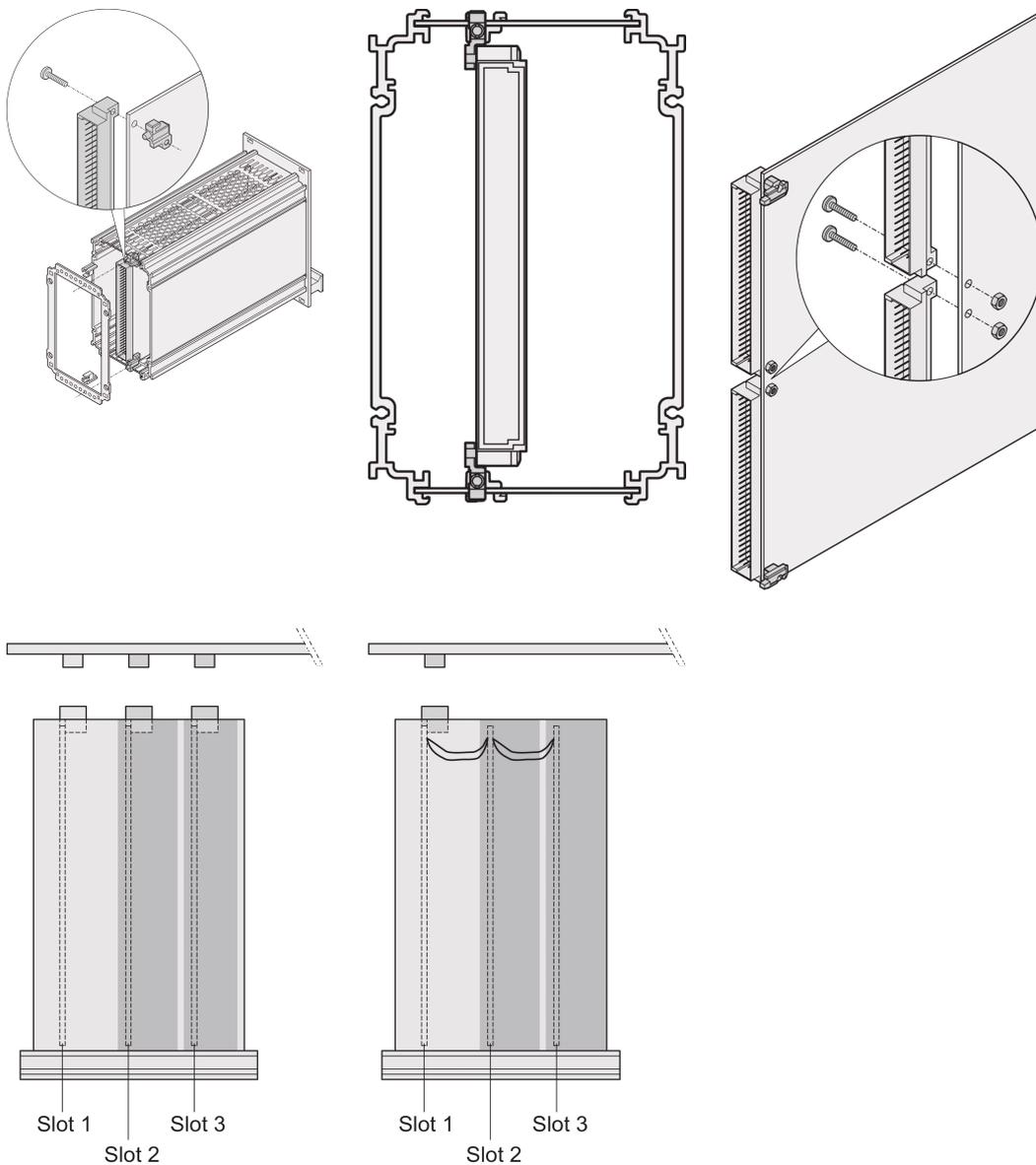
Die Leiterplatte wird in die Führungsschiene der linken Seitenwand bzw. des Seitenwand-Eckprofils ab Slot 2 eingeschoben.
