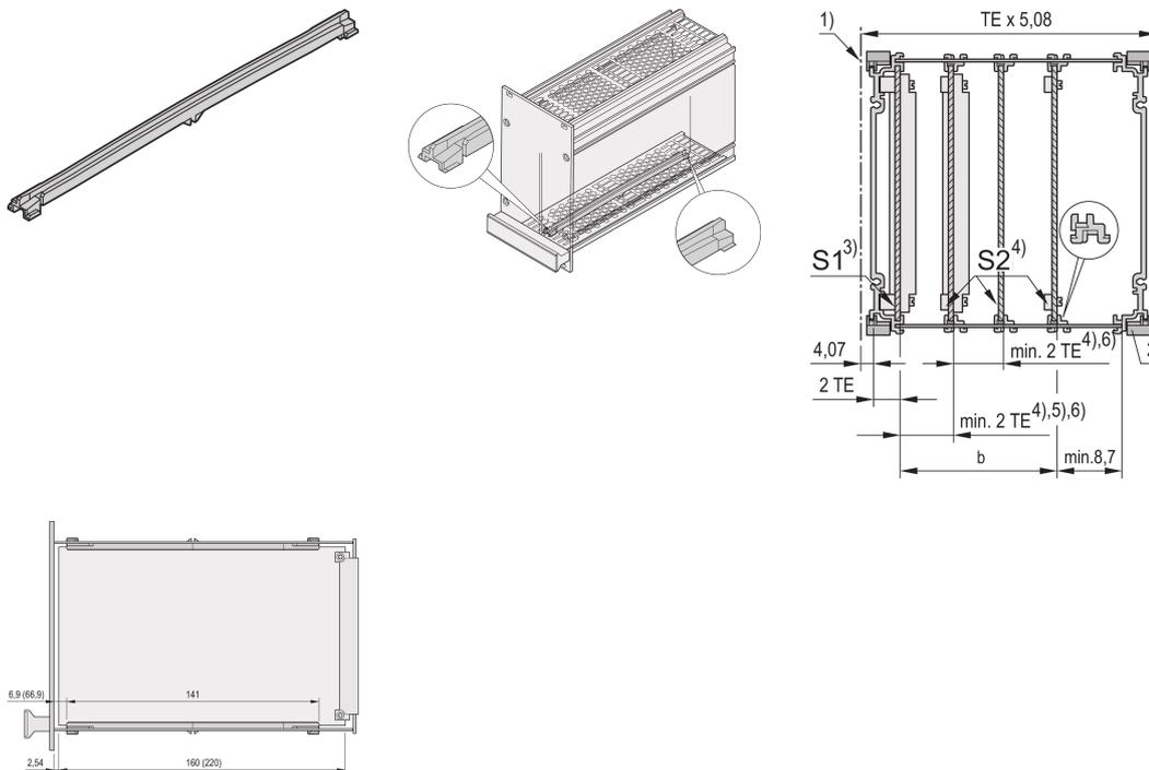
Die Führungsschienen können auf das perforierte obere / untere Deckblech geklipst werden. Dies ist erforderlich, wenn die Leiterplatte aus Slot 2 bestückt werden soll.
