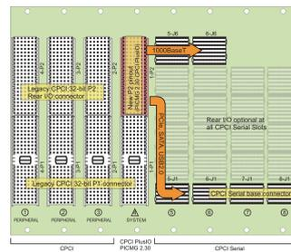
4 HE CompactPCI PlusIO System mit vertikalem Kartenkorb für einen CPCI PlusIO System Controller, 4 CompactPCI und 3 CompactPCI Serial Peripherie-Boards und ein steckbares CompactPCI 3 HE Netzteil
