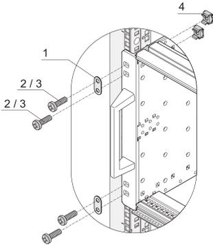
Zur Befestigung eines Baugruppenträgers mit zwei Befestigungsbohrungen an 19-Zoll Montagewinkeln (z. B. Rugged- und Bahn-Baugruppenträger).
