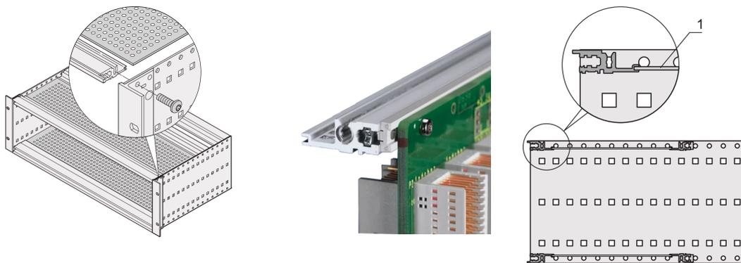
Mechanische Abdeckung von Einbauten. Die Platte wird in eine Nut der Modulschienen Typ L eingeschoben.
