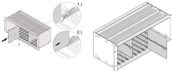
Das Splitting Kit wird in die entsprechende Aufnahme der nVent SCHROFF MicroTCA Führungsschiene eingesetzt und rastet in den entsprechenden Zapfen der Führungsschiene ein
