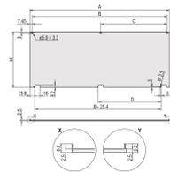
U-Profil-Frontplatte, Scharnier klappbar für Textildichtung.
