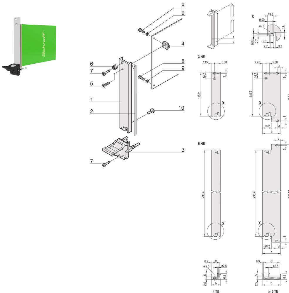
Steckbaugruppe, mit IEL-Einhebe-/Aushebegriff schwarz Griff, 3 HE, Frontbaugruppe. Die U-förmige Frontplatte ermöglicht die Abschirmung mit einer Textildichtung.
