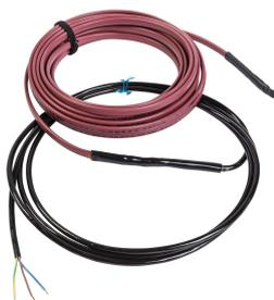
Die nVent RAYCHEM-Garnituren bestehen aus dem selbstregelnden 10XL2-ZH-Heizband mit vorinstalliertem LSZH-Kaltleiter (raucharm, halogenfrei) von 4 m Länge, einem Kaltleiter-Heizband-Adapter und einem Endabschluss. Die Garnituren gibt es in festen Längen zwischen 3 und 30 m. Werksseitig konfektioniert und elektrisch getestet.
