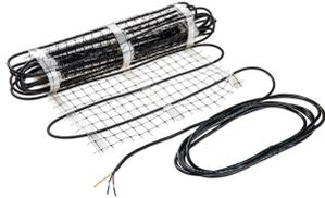
nVent RAYCHEM WinterGard Mat/Mesh (Matte/Geflecht) (\*) sind Heizmatten mit Konstantleistung für eine schnelle und effektive Aufheizung von Rampen und Zufahrten, um die Bildung von Schnee und Eis zu verhindern. Vordefinierte Leistung und vorkonfektioniert, erhältlich in verschiedenen festen Längen für die Installation auf Beton, Estrich und Asphalt.
