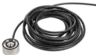
nVent RAYCHEM RAYSTAT-M2-G-SENSOR ist ein Bodentemperatur- und Feuchtesensor zum Einbetten in Oberflächen im Freien. Wird mit dem RAYSTAT-M2 Thermostat verwendet, um sicherzustellen, dass das Heizsystem nur dann mit Strom versorgt wird, wenn die Oberflächentemperatur unter dem gewählten Wert liegt und Schnee oder Eis auf dem Sensor liegt.
