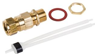
nVent RAYCHEM C25-100-METAL und C3/4-100-METAL sind kalt aufgebrachte Metallverbindungs-Kits zum Anschließen aller selbstregelnden und leistungsbegrenzenden nVent RAYCHEM-Parallel-Heizbänder für den industriellen Einsatz an einen Metall- oder Kunststoff-Anschlusskasten mit interner Erdungsplatte. C25-100-METAL für M25 Bohrungen, C3/4-100-METAL: für 3 / 4" NPT-Eingänge.
