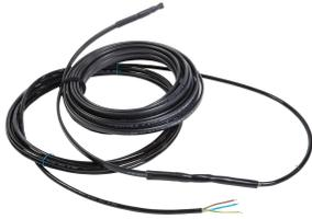
Selbstregelnde nVent RAYCHEM IceStop-Begleitheizungssets ermöglichen den Frostschutz von Dächern und Dachrinnen, für alle gängigen Materialien von Dachrinnen und Abflussrohren geeignet. Leistung beträgt 36 W/m bei 0 °C in Eiswasser, 18 W/m bei 0 °C in der Luft.
