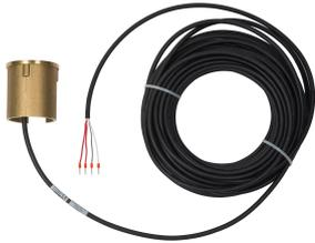
Bodensensor zur kombinierten Messung von Temperatur- und Feuchtwerten in begehbaren oder befahrenen Außenbereichen. Robuste Ausführung aus Messing, voll gekapselt. Sehr geringe Einbauhöhe, daher besonders gut geeignet für Treppenhäuser, Terrassen etc.
