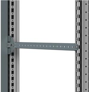
Diese Verstärkungshalterung macht die in der Tiefe anpassbare Montageplatte steifer, wodurch Vibrationen reduziert werden und mehr Gewicht aufgenommen werden kann.
