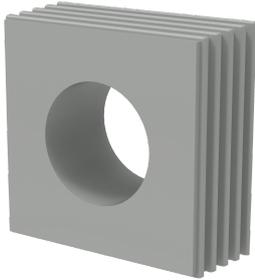
CCFG-Tüllen werden zusammen mit den CCFI- und CCFO-Kabeleinführungssystemen verwendet. Die spitz zulaufende Form der Tülle erleichtert das Eindrücken der Tülle. Das wellenförmige Profil erleichtert die Installation und gewährleistet einen festen Sitz um die einzelnen Kabel.
