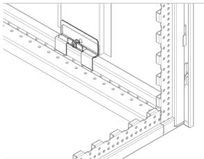
Die Innenhalterung lässt sich leicht und ohne Bohren montieren und erlaubt das Entfernen der Rückwand nur von innen. Die Sicherung ist nur für IP 20-Anwendungen gedacht.
