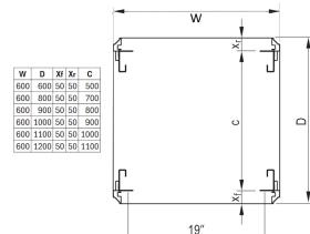
Varistar geschweißter Stahlrahmen für statische Lastanforderungen. Für 19-Zoll-, ETSI- oder Montageplattenintegration.
