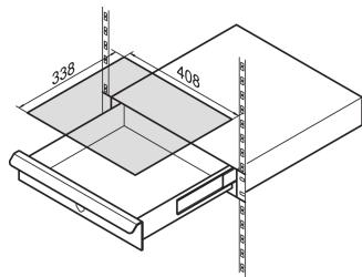
19"-Schubladen zur Montage von Laptops oder als Schreibunterlage für einfache Arbeiten. Die SCHROFF 19"-Schublade hat eine Tragfähigkeit von 15 kg, sodass eine breite Palette von Produkten darauf montiert werden kann.
