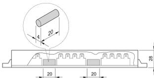
Isolieranschlage fur Sammelschienen zum Schutz der Klemmen vor versehentlichen Kurzschlussen und Beschadigung. Die Anschlage bieten eine starre Verbindung zur physischen Trennung der Schranksammeleisen von allen Stromquellen und sind fur einfache Befestigung der Sammelschiene ausgelegt.
