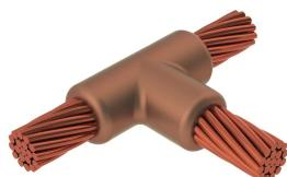
Ursprünglich wurden hochbelastbare Verbindungen für den Einsatz auf Altkabel entwickelt. Die schweren Verbindungen verwenden einen größeren Anschlussraum in der Form und mehr Schweißmaterial als die gleichwertige Standardverbindung.
