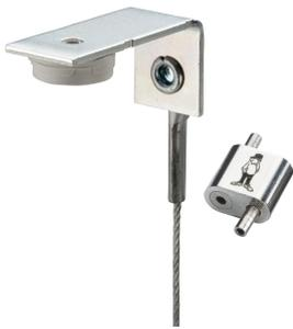
Das nVent CADDY Speed Link-Light Pack mit Befestigungswinkel mit Schubbolzenadapter enthält eine vorgeschchnittene Länge (1m und 2m) Drahtseil mit einem Durchmesser von 1mm, das auf einer Winkelhalterung für die direkte Befestigung vernietet ist, und einen ultraflachen Verschluss. Installateure können es schnell und sicher mit einer Vielzahl von Schubbolzengeräten an der Betondecke anbringen, um Beleuchtungskörper und Beschilderungen zu befestigen.
