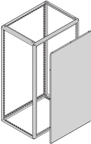
Schottwand ersetzt bei angereihten Schränken 2 Einzelschrank-Seitenwände. Die Schottwand wird zwischen Schränken montiert und ist voll kompatibel mit allen Luftschottblechen.
