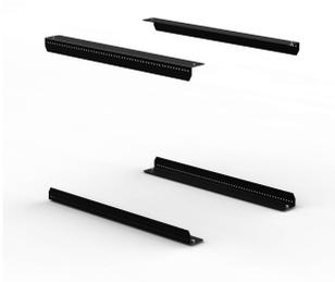
Seitliche Tiefenstrebe zur Stütze von 19-Zoll-Holmen in einem 800 mm breiten Schrank für eine statische Last von 800 kg. Das Lochraster ermöglicht eine einfache Neuplatzierung der 19-Zoll-Ebene in 25 mm-Abständen.
