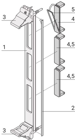
U-förmige Frontplatte mit Ausbruch für PMC. Abschirmbar für EMV-Dichtung (Textil).
