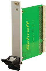
Steckbaugruppe, mit IEL-Einhebe-/Aushebegriff schwarz Griff, 3 HE, Rear I/O-Montage. Die U-förmige Frontplatte ermöglicht die Abschirmung mit einer Textildichtung.
