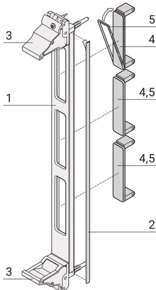
Die FMC-Blenden nach Vita 57,1-Spezifikation. Deckt den Ausbruch in der gesamten Frontplatte ab.
