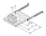
Schrankmontagekit für Teleskopschienen für die Montage von 2 Economy 1 HE Teleskopschienen.
