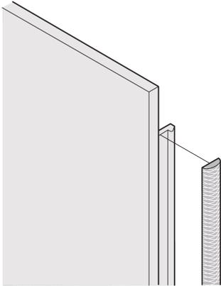
EMV-Textildichtungen werden seitlich in die Nut auf der rechten Seite der U-förmigen Frontplatte eingebracht. Die Dichtungen werden auf die Frontplatte geklebt.
