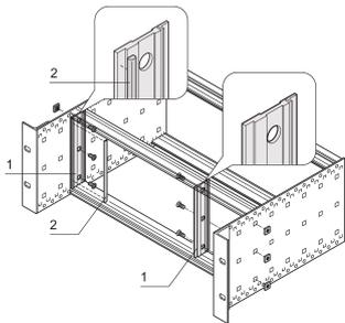
Zur vertikalen EMV-Schirmung (Textil) zwischen tiefenversetzten geschirmten Frontplatten und Seitenwand.
