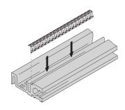
Die Edelstahldichtung wird in eine Nut der Modulschiene eingeklipst und stellt den Kontakt zum Abdeckblech her.
