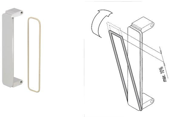
Die O-Ring-Dichtung kann zur EMV-Abschirmung von PMC- oder FMC-Mezzanines verwendet werden. Der O-Ring wird in die Nut des Mezzanines montiert.
