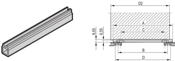
Führungsschienen Mittelteil für individuelle mehrteilige Führungsschienen aus Kunststoff oder Aluminiumprofil. Geeignet für Endstücke vom Typ Standard, Zubehör, 4,4-Zoll und Endstücke mit Codierung.
