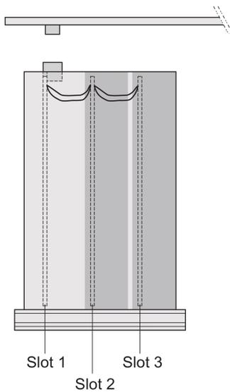
Schützt eine Leiterplatte vor mechanischer Beschädigung und entlädt elektrostatische Aufladung; für Europakartenformate; mit Platte mit einem Ausbruch für einen Steckverbinder kombinieren.
