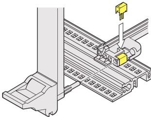
Der ESD-Clip kann in den Codierblock der Führungsschiene mit Codierung eingesteckt werden. Er sorgt für einen leitfähigen Kontakt zwischen dem Führungsstift des Ein-/Aushebegriiffs (IEL oder IET) und der Modulschiene.
