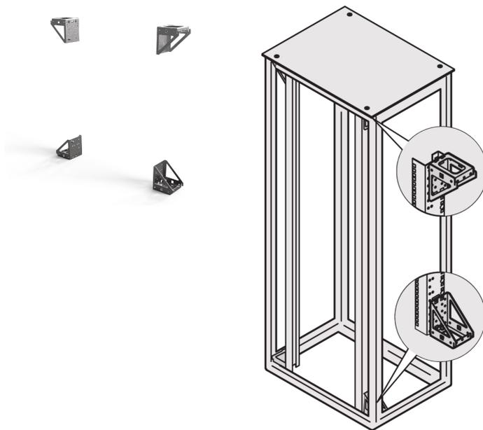
Varistar Adapterwinkel für eine reduzierte Breite zur Montage von 2 Winkelprofilen. Wird geliefert in Kombination mit Tiefenstrebenmontage, vertieft von verkürzten 19-Zoll Winkelprofilen.
