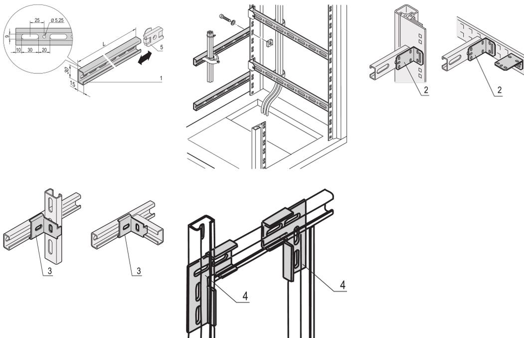
Zur Montage an den vertikalen Holmen auf der rechten und linken Seite der 19-Zoll-Ebene; besonders geeignet für Kabelschellen.
