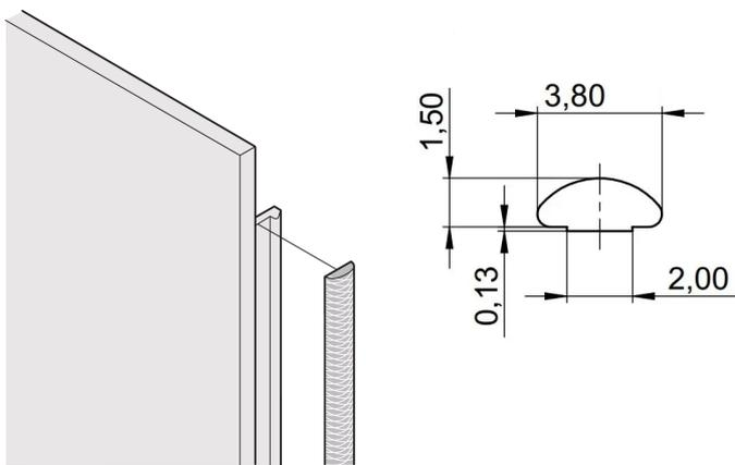
EMV-Textildichtungen werden seitlich in die Nut auf der rechten Seite der U-förmigen Frontplatte eingebracht. Die Dichtungen werden auf die Frontplatte geklebt.
