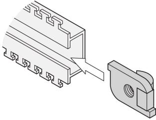
C-Schienen dienen dem besseren Kabelmanagement. Die Installation erfolgt in der Regel hinter den 19-Zoll-Holmen. Sie sind kompatibel mit Standard-Kabelschellen.
