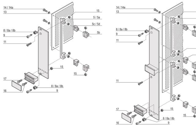
Nippel dient als Führung der Halsschraube beim Befestigen der Frontplatte.
