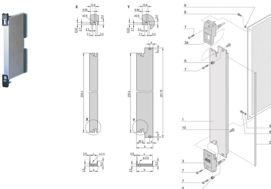
Steckbaugruppen-Bausatz mit schwarzem IEL-Einhebe-/Aushebegriff, 3 HE, Frontmontage. Die U-förmige Frontplatte ermöglicht die Abschirmung mit einer Textildichtung.
