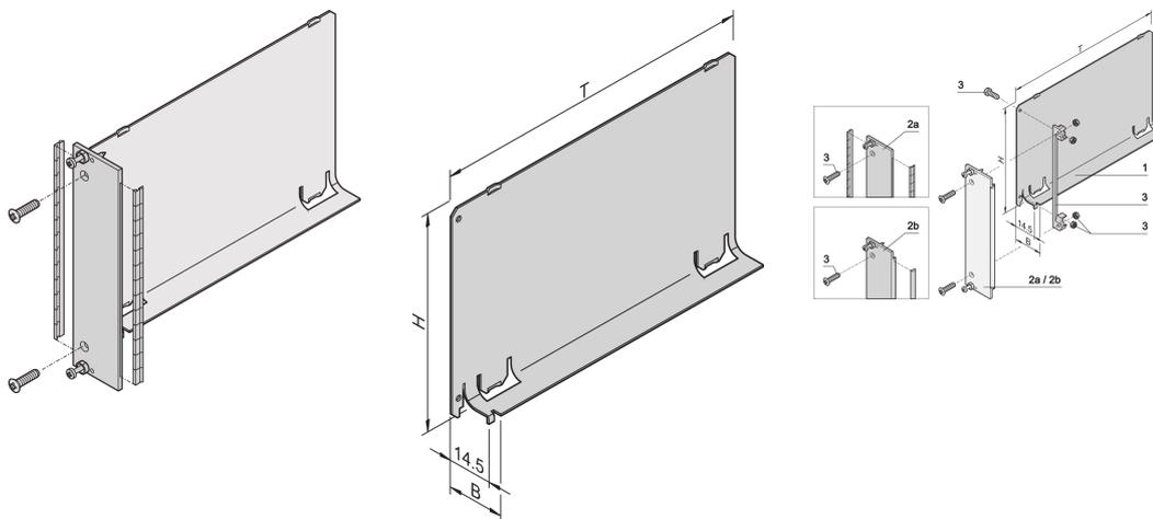
Das Luftleitblech mit flacher Frontplatte deckt einen leeren Slot ab, damit keine Luft entweicht. Die flache Frontplatte eignet sich für eine EMV-Dichtung aus Edelstahl.
