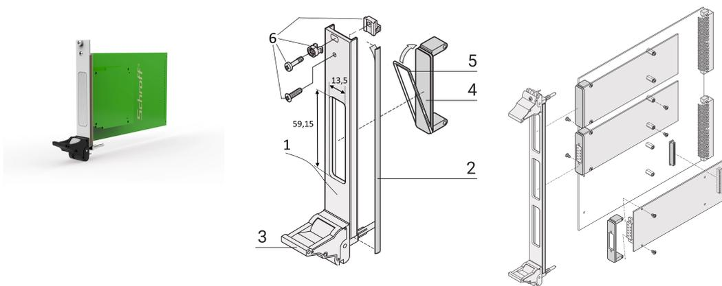
Die FMC-Blenden nach Vita 57,1-Spezifikation. Deckt den Ausbruch in der gesamten Frontplatte ab.
